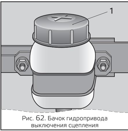
Рис. 62. Бачок гидропривода выключения сцепления
