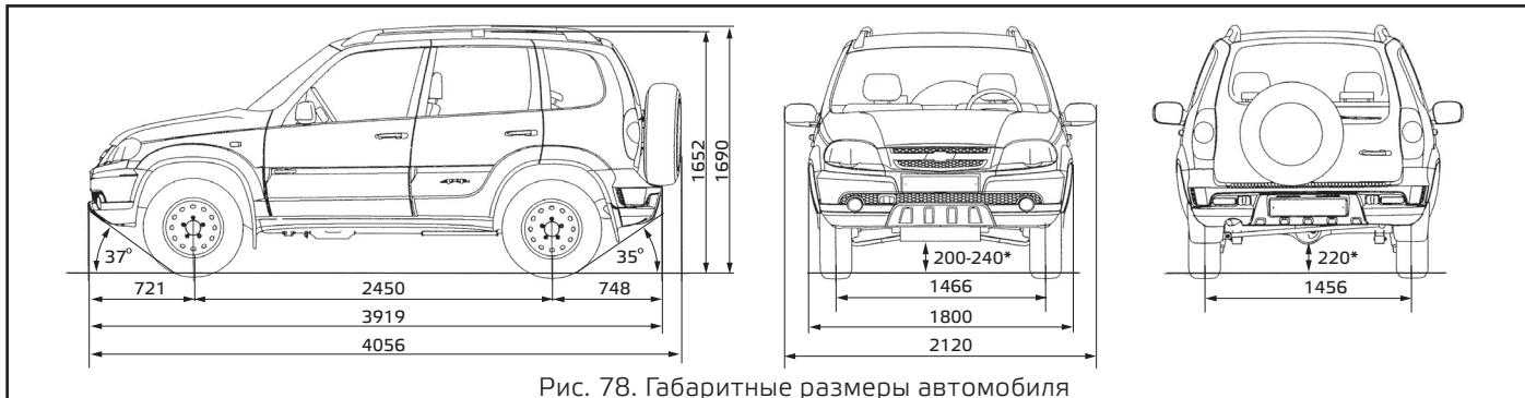
Рис. 78. Габаритные размеры автомобиля
