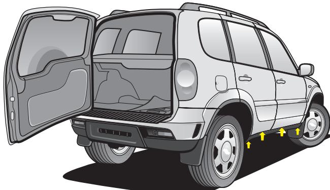
Рис. 77. Дренажные отверстия дверей и порогов
