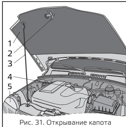
Рис. 31. Открывание капота
