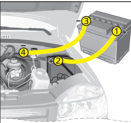
Рис. 57. Подключение кабелей
