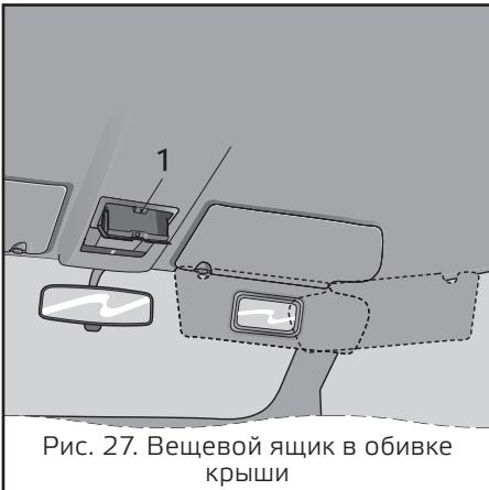
Рис. 27. Вещевой ящик в обивке крыши
