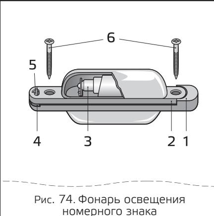
Рис. 74. Фонарь освещения номерного знака
