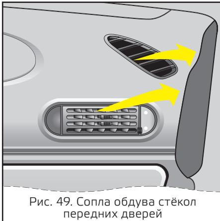
Рис. 49. Сопла обдува стёкол передних дверей
