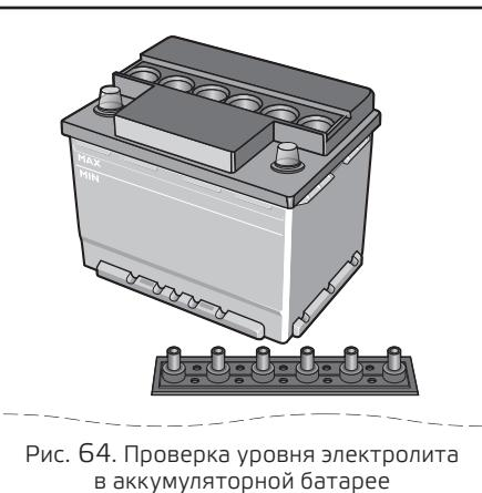
Рис. 64. Проверка уровня электролита в аккумуляторной батарее
