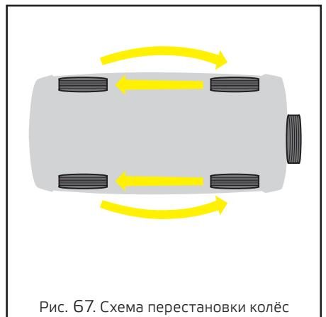
Рис. 67. Схема перестановки колёс
