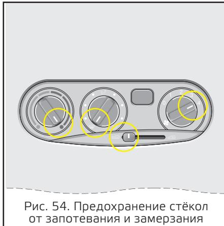
Рис. 54. Предохранение стёкол от запотевания и замерзания
