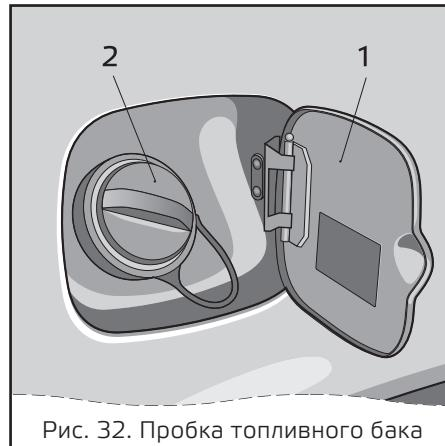
Рис. 32. Пробка топливного бака
