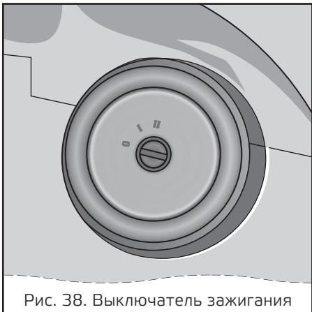
Рис. 38. Выключатель зажигания
