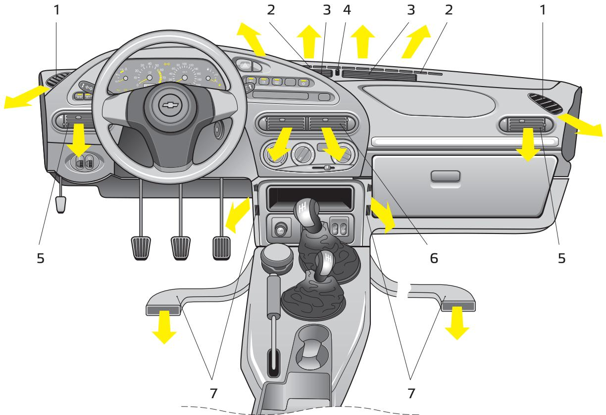
Рис. 44. Органы управления системой вентиляции и отопления салона
