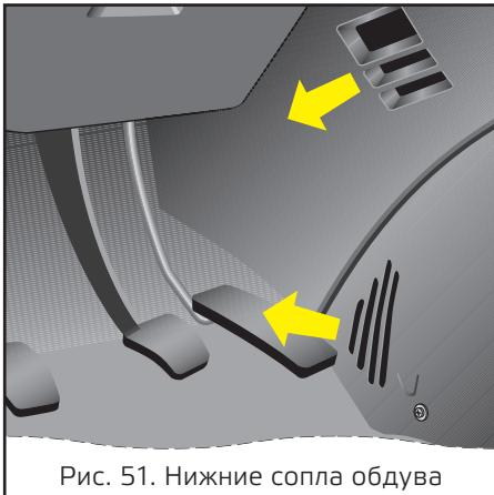
Рис. 51. Нижние сопла обдува
