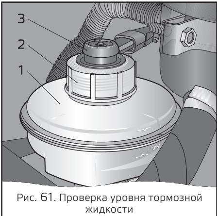
Рис. 61. Проверка уровня тормозной жидкости
