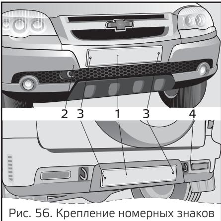
Рис. 56. Крепление номерных знаков
