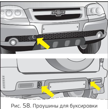
Рис. 58. Проушины для буксировки
