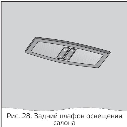
Рис. 28. Задний плафон освещения салона
