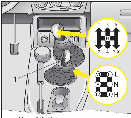
Рис. 40. Положения рычагов трансмиссии
