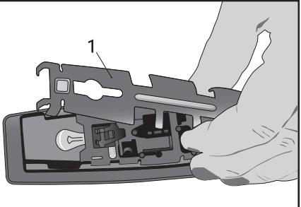
Рис. 73. Задний плафон освещения салона
