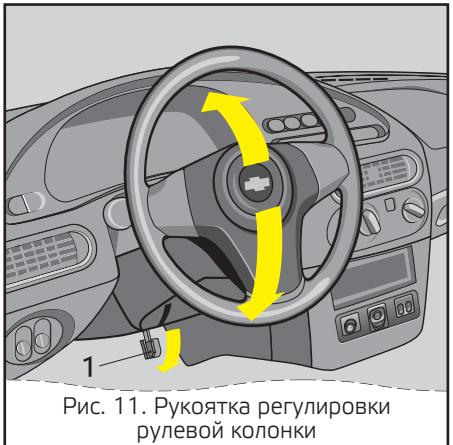
Рис. 11. Рукоятка регулировки рулевой колонки
