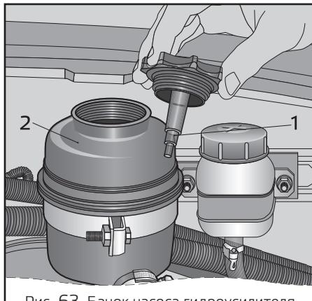
Рис. 63. Бачок насоса гидроусилителя
