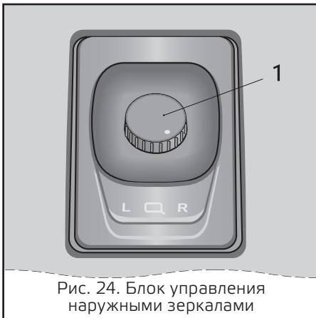
Рис. 24. Блок управления наружными зеркалами
