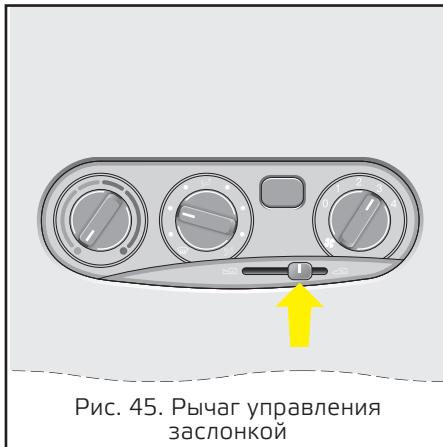
Рис. 45. Рычаг управления заслонкой
