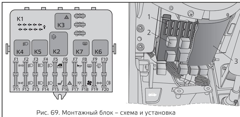
Рис. 69. Монтажный блок – схема и установка
