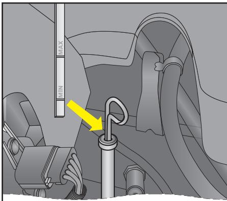
Рис. 59. Проверка уровня масла в картере двигателя
