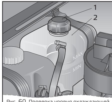
Рис. 60. Проверка уровня охлаждающей жидкости в расширительном бачке
