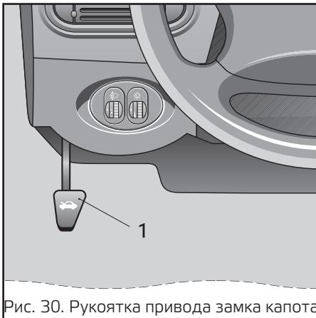
Рис. 30. Рукоятка привода замка капота
