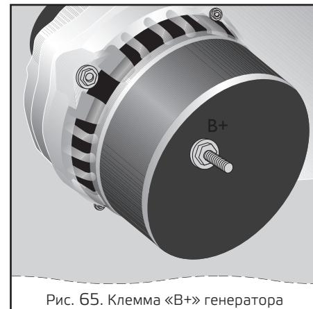
Рис. 65. Клемма «B+» генератора
