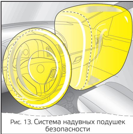
Рис. 13. Система надувных подушек безопасности
